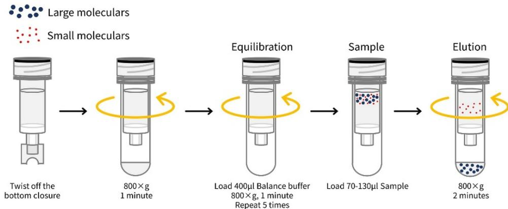
图2. 碧云天BeyoDesalt™ G-25 Spin脱盐柱(P2613)离心法使用方法示意图。
