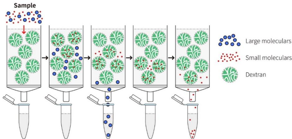
图1. 碧云天BeyoDesalt™脱盐柱的工作原理图。
